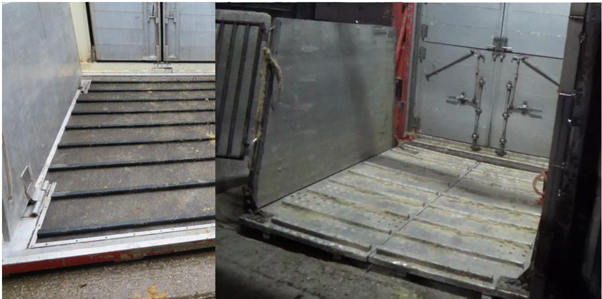
Figuur 5: links een gecoate (uit)laadklep, rechts: niet-gecoate klep wat resulteert in meer uitglijden van de kalveren.
