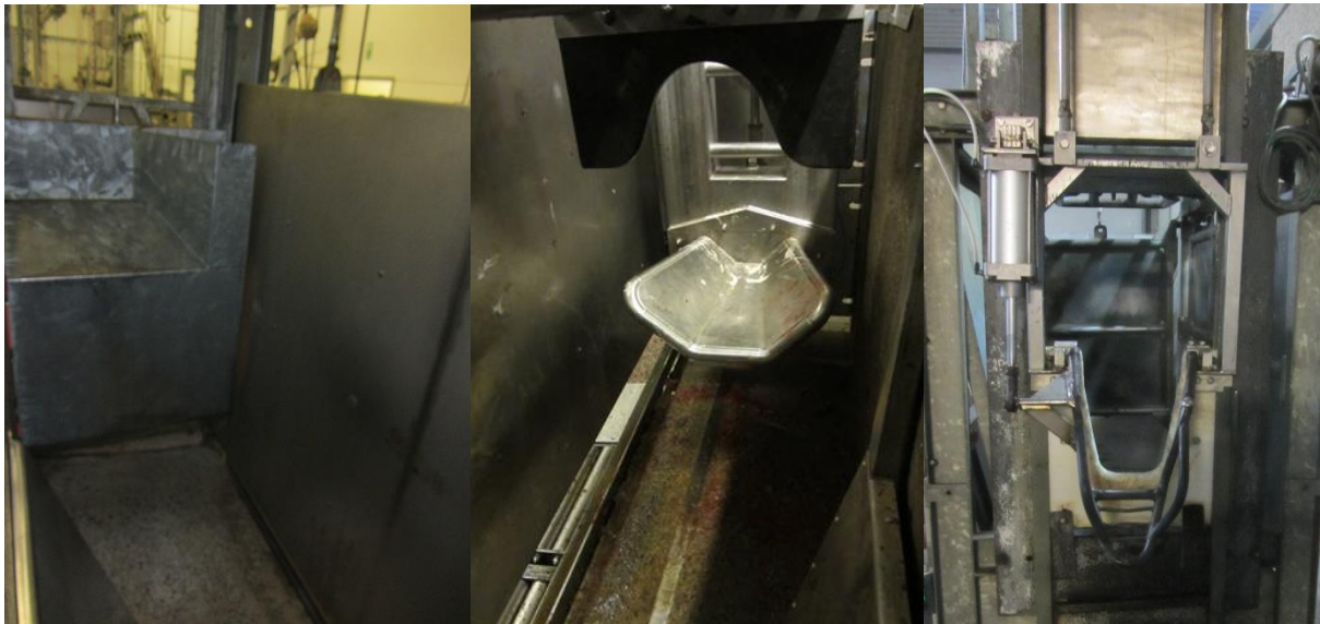
Figuur 12: Links: uitsparing in de box om de kop te positioneren; midden: fixatie van kop en hals bij gebruik van een pneumatisch penschiettoestel; rechts: mogelijkheid tot fixeren van de kop buiten de box, maar wordt doorgaans enkel gebruikt bij ritueel slachten.
