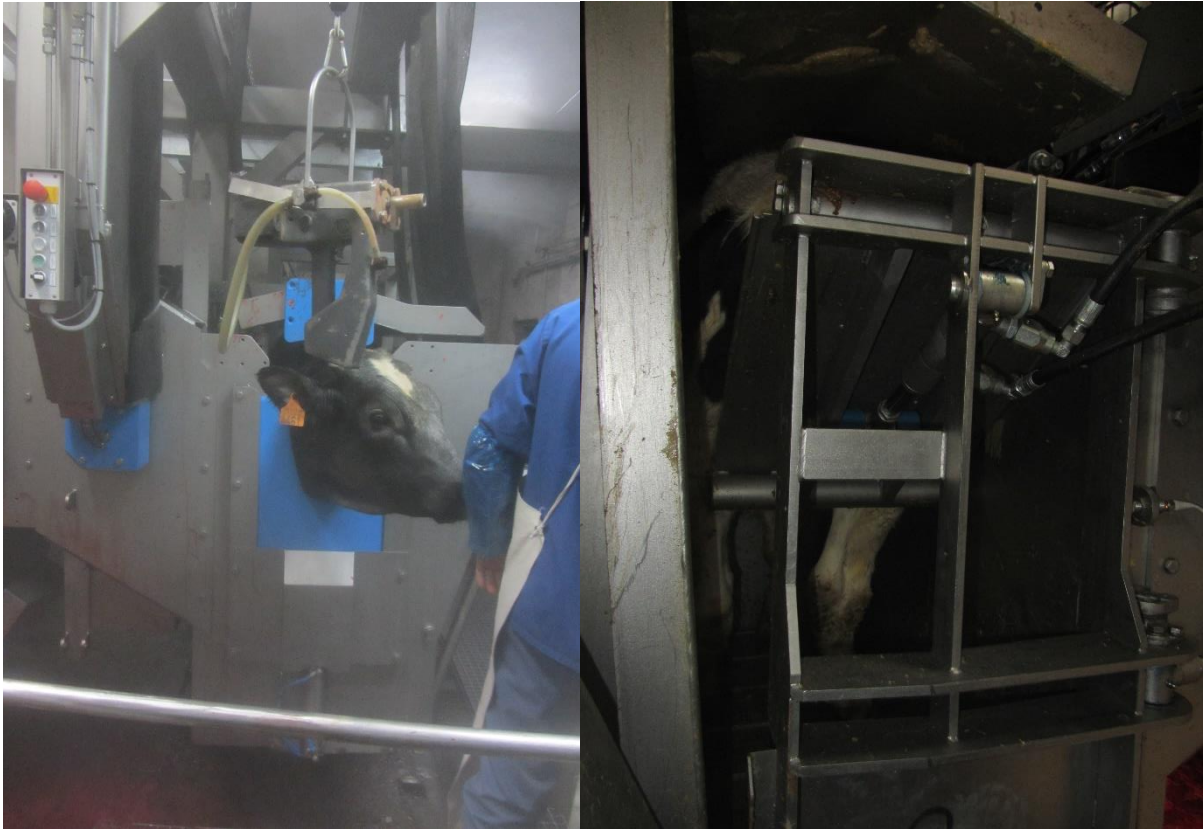
Figuur 13: foto links: voorzijde twinbox met bovenaan hetpneumatisch penschiettoestel, het kalf wordt in deze positie bedwelmd en vervolgens 180° geroteerd; foto rechts: achterzijde van de twinbox met achterhandstuwer.
