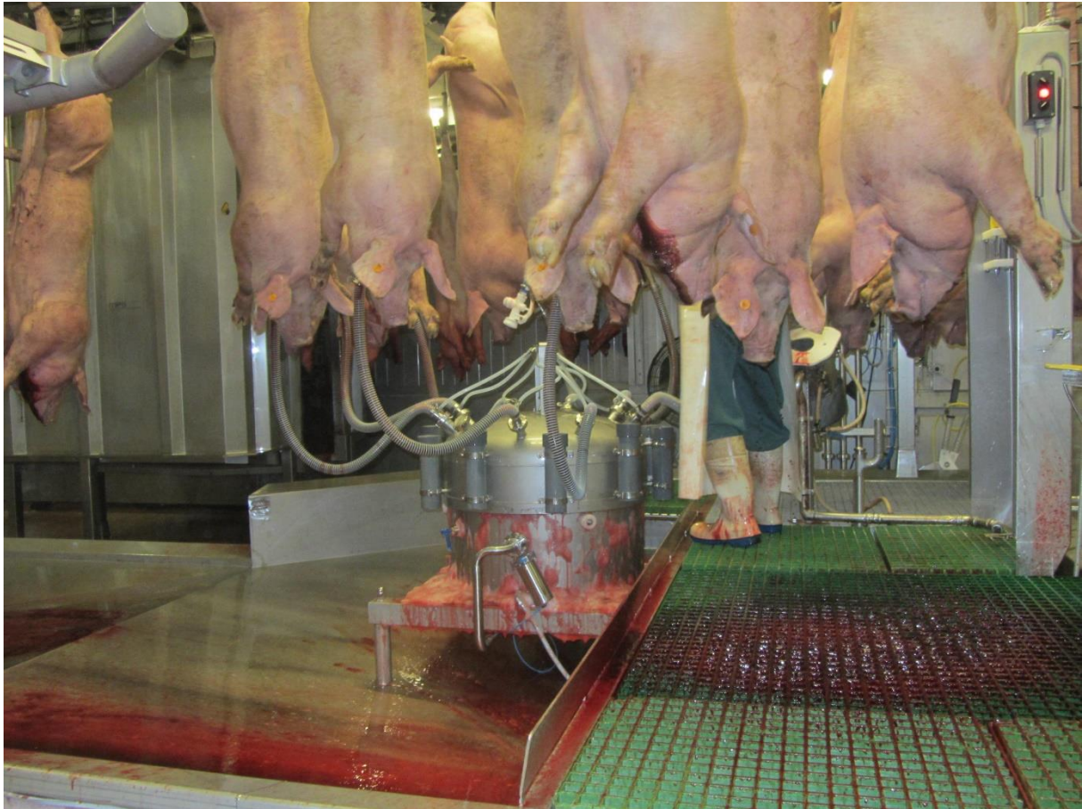
Figuur 24: Een carrouselstelsel om varkens te verbloeden en het bloed te capteren.
