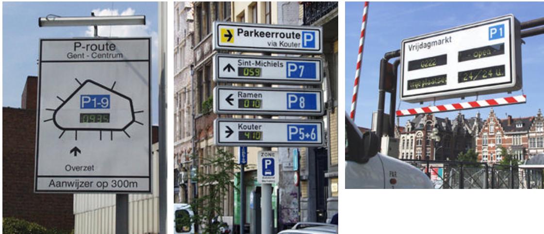
Figuur 12 Dynamische borden, van links naar rechts: overzichtsbord, signaleringsbord en inritbord
